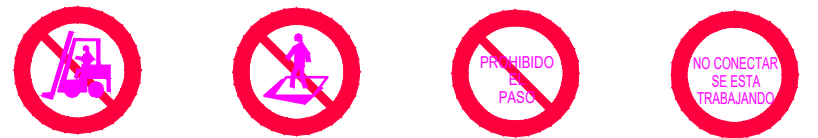
PROHIBIDO EL PASO A CARRETILLAS PROHIBIDO PISAR SUELO NO SEGURO PROHIBIDO EL PASO NO CONECTAR SE ESTA TRABAJANDO
