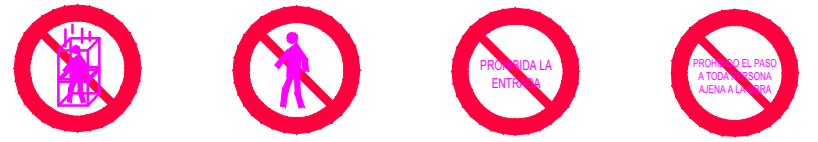
PROHIBIDO A PERSONAS PROHIBIDO EL PASO A LOS PEATONES PROHIBIDA LA ENTRADA PROHIBIDO EL PASO A TODA PERSONA AJENA A LA OBRA
