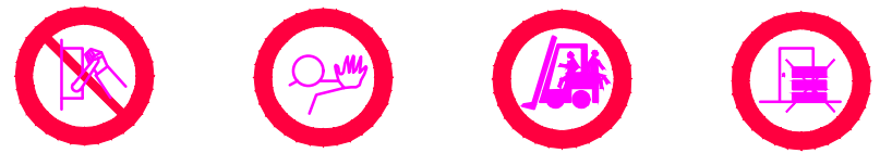
PROHIBIDO ACCIONAR ALTO NO PASAR PROHIBIDO ACOMPAÑANTES EN CARRETILLA PROHIBIDO DEPOSITAR MATERIALES
