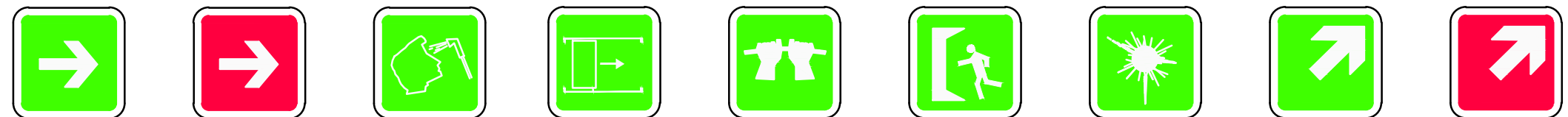
VIAS DE EVACUACION LOCALIZACION SALIDAS CONTRA INCENDIOS LAVA OJOS SALIDA DE SOCORRO DESLIZAR PARA ABRIR SALIDA DE SOCORRO EMPUJAR LA BARRA PARA ABRIR SALIDA A UTILIZAR EN CASO DE EMERGENCIA ROMPER PARA PASAR VIAS DE EVACUACION LOCALIZACION SALIDAS CONTRA INCENDIOS
