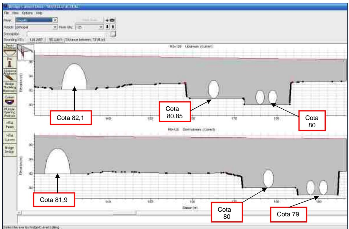
Completará la actuación la modificación de cotas de la vía de servicio, para que a diferencia de la situación actual, y mediante un rebaje de la cota de su calzada, se facilite la evacuación del caudal hacia el arroyo natural, aliviando el agua de la lámina de inundación del otro lado de la autovía, y sobre todo evitando que se siga produciendo la situación actual de encharcamiento y acumulo de barro que de manera prácticamente permanente se produce en las estaciones de lluvia.
