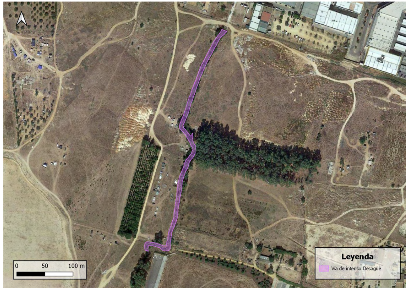
Imagen 42 – Delimitación de la Vía de Intenso Desagüe (VID).
