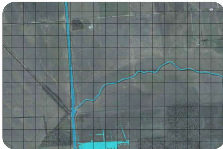
Imagen 14 – Ejemplo de flujo en canales pequeños circulando por celdas de gran tamaño.
