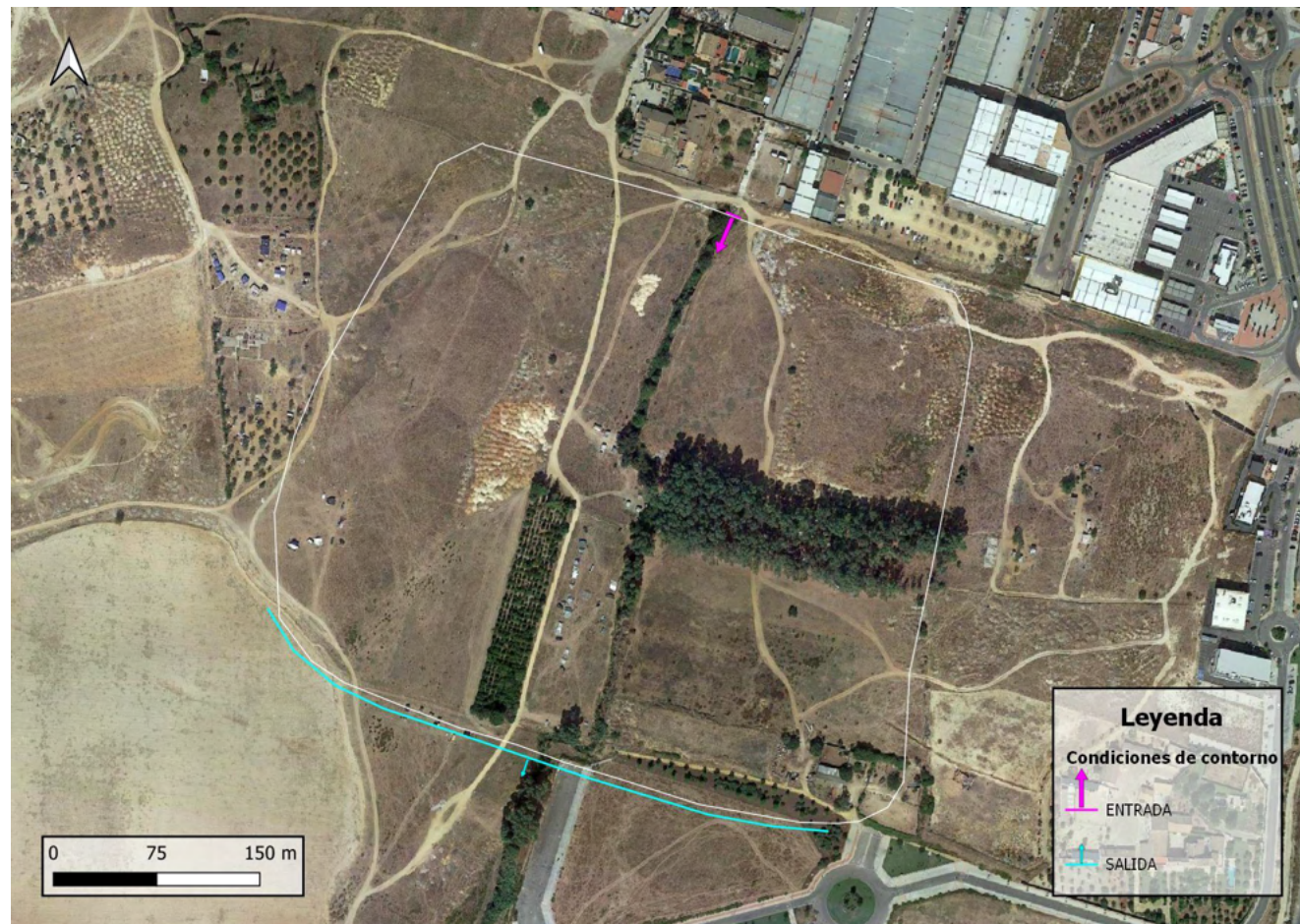
Imagen 20 – Condiciones de contorno del modelo de cálculo hidráulico.
